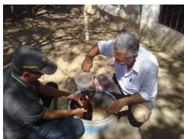
Figura 60. Procedimentos de coleta de efluentes para dimensionamento das ETEs das empresas de laticínios
