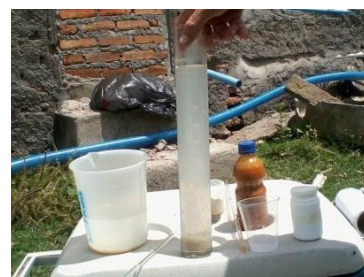
Figura 60. Procedimentos de coleta de efluentes para dimensionamento das ETEs das empresas de laticínios
