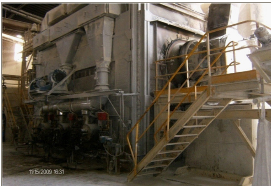
Foto 3.6: Forno marmita rotativo queimando BPF. Fonte: Supergesso S/A - Araripina - PE
