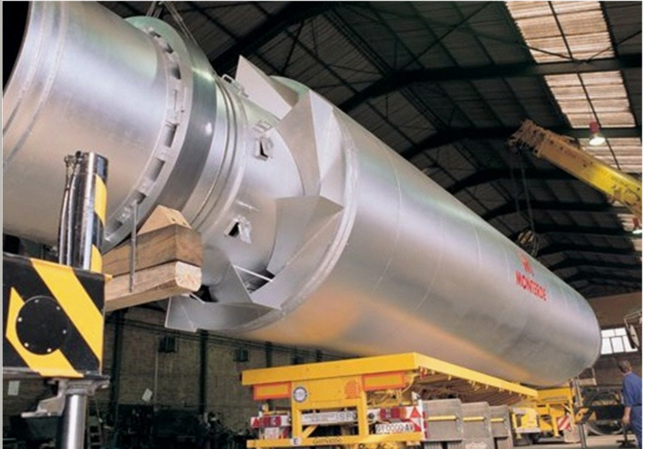
Foto 2.2: Forno de calcinação Monterde - mod. ARAMIR. Fonte: Talleres Monterde, Barcelona - Espanha
