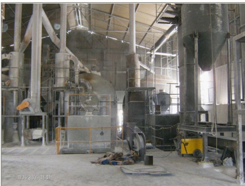
Foto 3.7: Forno tipo marmita rotativa SMT queimando coque. Fonte: SM Tanques - Araripina/PE
