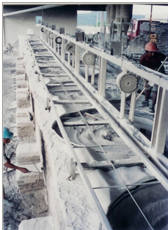
Foto 3.1: Fábrica de gesso utilizando fornos panela. Fonte: Supergesso S/A - Araripina - PE
