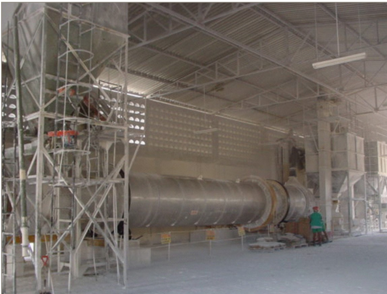
Foto 3.4: Forno Tubular Rotativo. Fonte: Gesso Trevo, Trindade/PE
