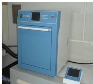
DIGESTOR DE AMOSTRAS POR MICROONDAS
