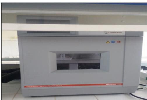
Figura 04- Micro-ondas para extração de OeG
