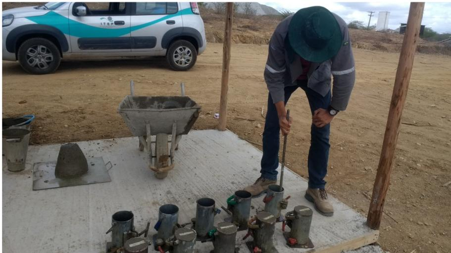
*Moldagem de corpos de prova de concreto nas obras de Pirangi*
