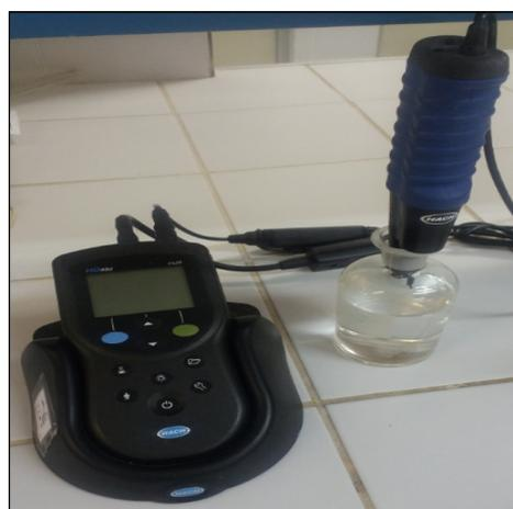
Figura 05-Sonda de Luminescência (LBOD)
