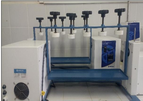
**Figura 07- Agitador Rotativo para não-voláteis**
