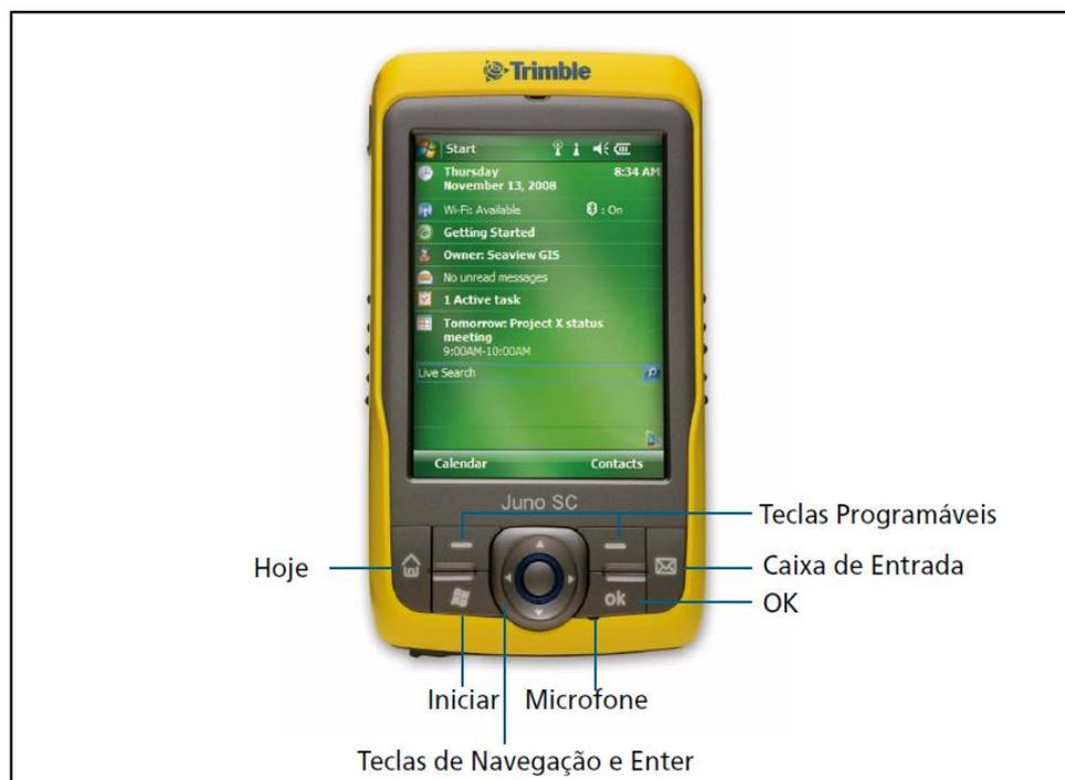
**Figura 8 - Coletor portátil de mapeamento digital**
