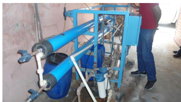
Figura 2.7-20 - Dessalinizador recuperado no Centro - Vertentes – PE.
