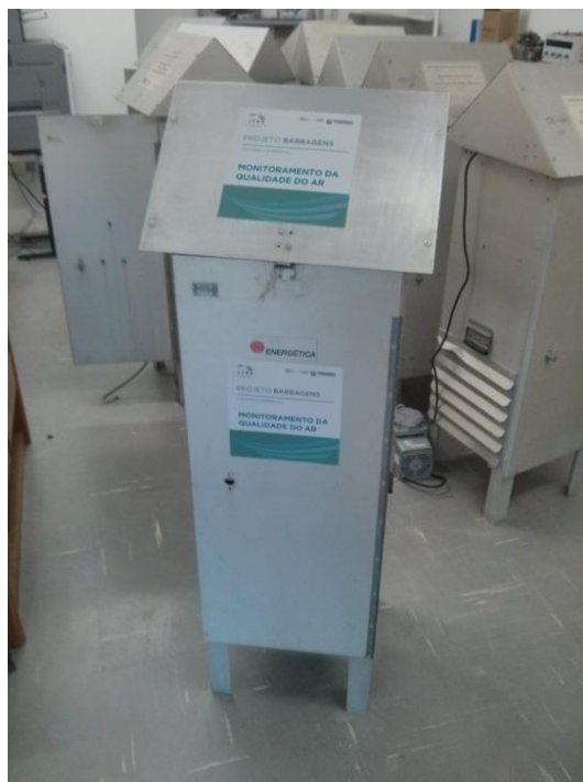
Figura 2.3-3 - HI-VOL - Equipamento utilizado para Monitoramento da Qualidade do Ar
