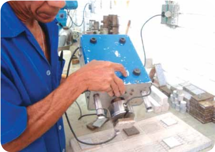
Ensaio de Arrancamento em argamassas colantes
